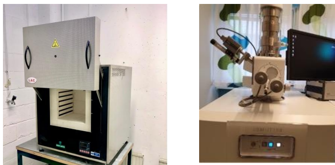
Figur 2. Ugn som användes i projektet för att exponera prover för 400°C och 800°C och svepelektronmikroskop som användes för karakterisering av prover utsatta för hög temperatur.
